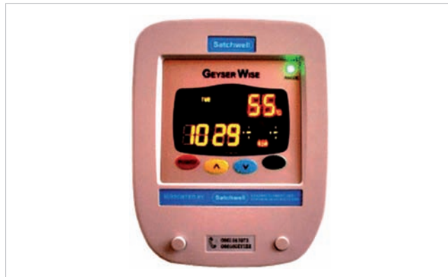
Obr. 5 Diferenciálny regulátor aktívneho systému
